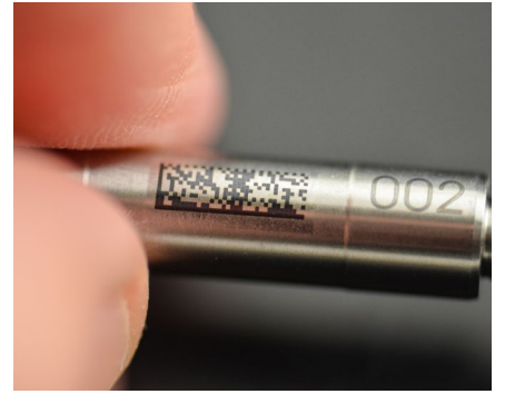
Marquage thermique sur acier inoxydable
