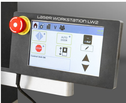
Écran tactile intuitif mode automatique sans ordinateur
