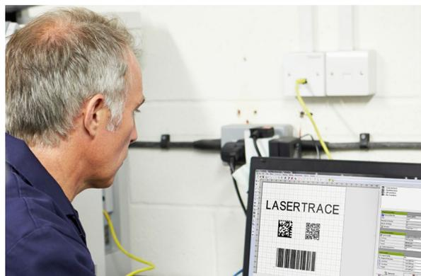
Lasertrace est un logiciel unique spécialement conçu pour créer des fichiers de marquage à charger dans le système laser. Il comprend une composition graphique pour ajouter du texte, des logos et des codes comme le Datamatrix dans vos modèles de marquage.
